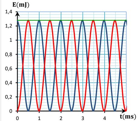
Évolution des énergies électrique  $E_e$ , magnétique  $E_m$  et totale  $E_t$  dans un circuit idéal LC.
