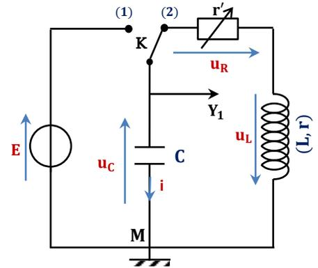
Schéma du montage expérimental
