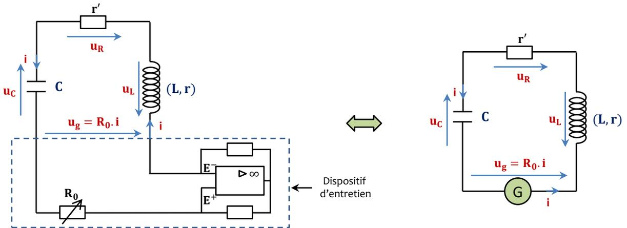
Schéma du montage expérimental (dipôle RLC branché au dispositif d'entretien).
