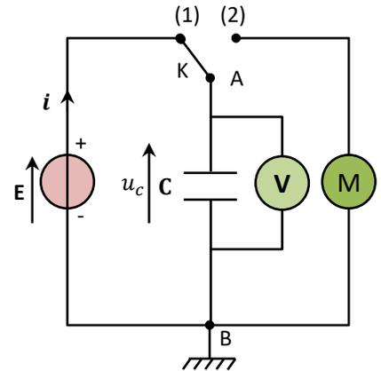
Schéma du montage expérimental
