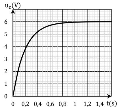
Évolution de la tension  $u_c(t)$  aux bornes du condensateur en charge.
