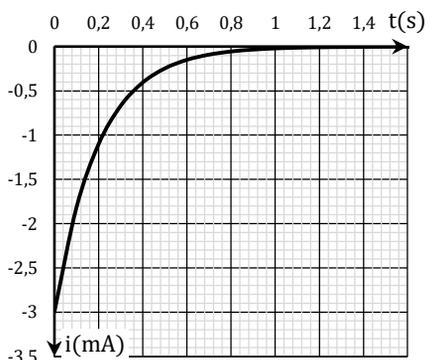
Évolution de l'intensité du courant  $i(t)$  dans le dipôle RC.
