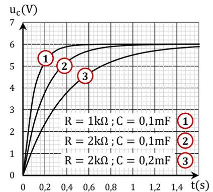
La charge d'un condensateur est plus lente quand le produit  $RC = \tau$  augmente.
