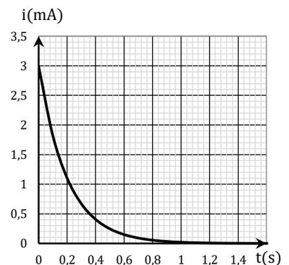
Évolution de l'intensité du courant  $i(t)$  dans le dipôle RC.
