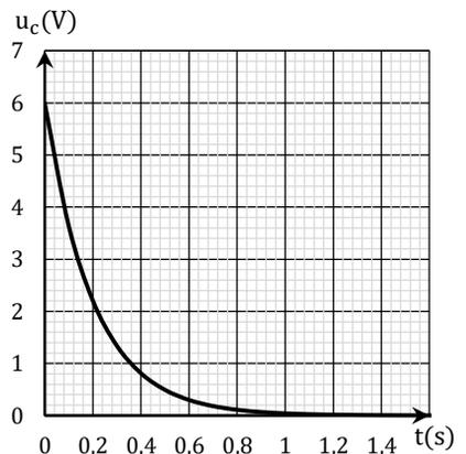
Évolution de la tension  $u_C(t)$  aux bornes du condensateur en décharge.
